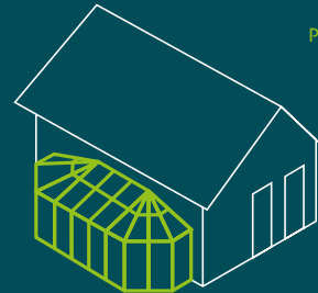
Pulldach – mit beidseitigem Polygon
